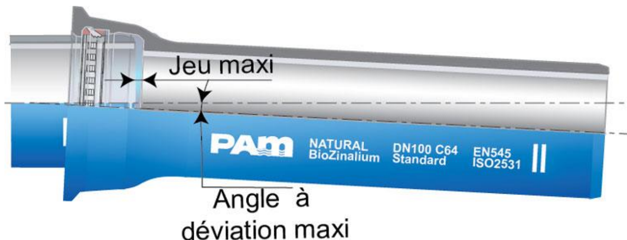
Figura 5 Sistema di giunzione tubo in ghisa
